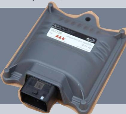
Блок управления ГБО А.Е.В. модели Alex32 предназначен для установки на простые двигатели без необходимости обработки допрысков
