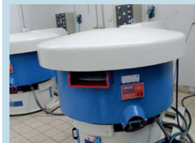
Миксеры со специальными кукурузными гранулами обеспечивают чистку и сушку изготовленных деталей. А для деталей, требующих полировки, в миксере используются керамические гранулы.
