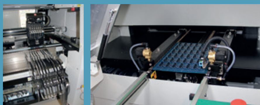
В этом станке рождается мозг ГБО. Бабины с микросхемами, робот по установке микросхем в платы, «паяльная» печь, контроль работы собранных плат – основные составляющие этапа производства электронных блоков управления.
