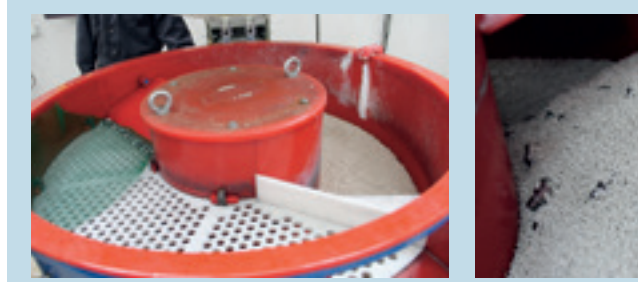
Миксеры со специальными кукурузными гранулами обеспечивают чистку и сушку изготовленных деталей. А для деталей, требующих полировки, в миксере используются керамические гранулы.
