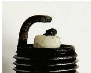
Внешний вид свечи с применением избыточного момента затяжки.
