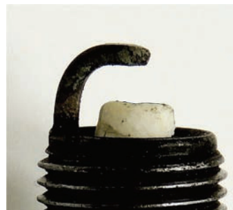
Внешний вид свечи с применением избыточного момента затяжки.
