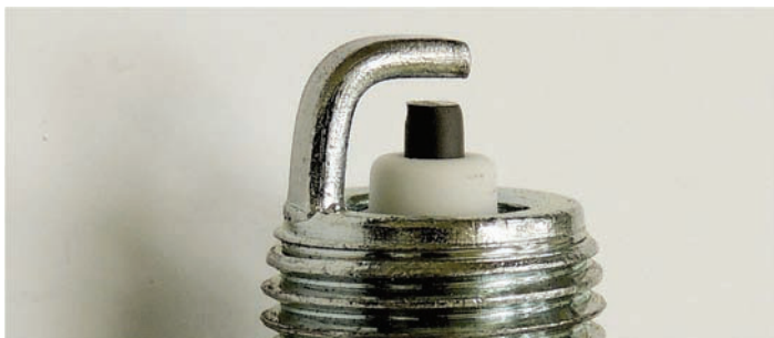
Внешний вид свечи с применением корректного момента затяжки.
